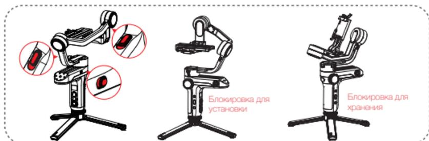
1. Выньте модуль быстросъемной площадки и нажмите кнопку для снятия быстросъемной площадки, чтобы вынуть быстросъемную площадку Arca.
