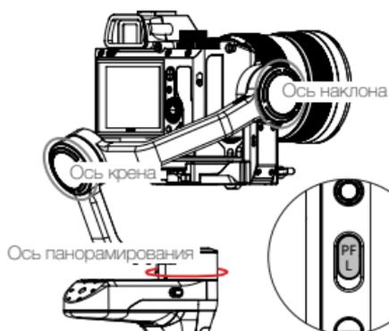
**Режим отслеживаемого панорамирования (PF):** сдвиньте переключатель PF/L вверх. Камера перемещается влево/вправо в соответствии с движением стабилизатора, а оси крена и наклона при этом заблокированы. Для ручного управления осью наклона сдвиньте джойстик вверх или вниз.
