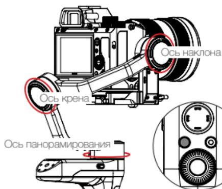
**Режим съемки от первого лица (POV):** нажмите кнопку POV один раз. В этом режиме все три мотора вращаются на 360°, следуя за движениями стабилизатора.
