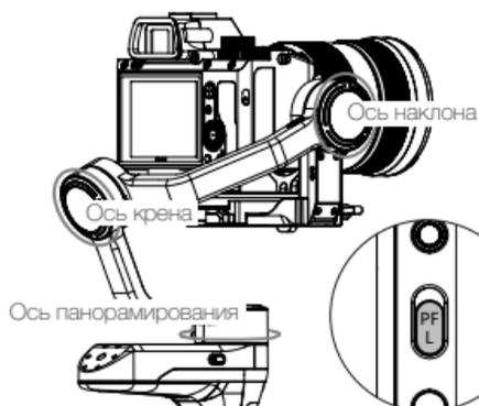
**Режим блокировки (L):** сдвиньте переключатель PF/L вниз. Блокирует движение по всем трем осям и фиксирует камеру для съемки в определенном направлении. Для ручного управления осью наклона сдвиньте джойстик вверх или вниз, для управления осью панорамирования — влево или вправо.
