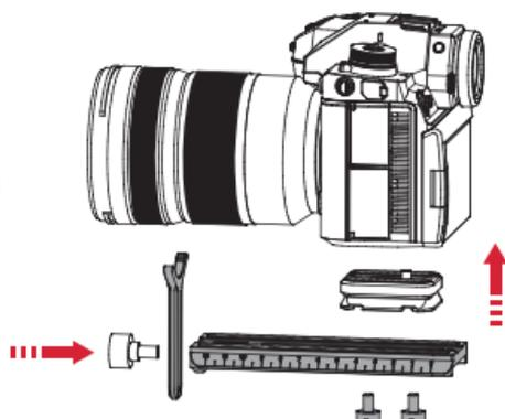
3. Ослабьте защелку быстросъемной площадки. Установите быстросъемную площадку вместе с прикрепленной к ней камерой на стабилизатор. Убедитесь, что она надежно установлена, а ее предохранительный замок защелкнулся.
