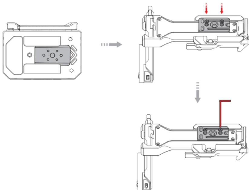
2. Установите передатчик AI таким образом, чтобы слот монтажной планки был направлен вверх. Выровняйте монтажную планку передатчика и переместите передатчик AI в сторону привода оси наклона до щелчка, чтобы обеспечить надежную установку.
