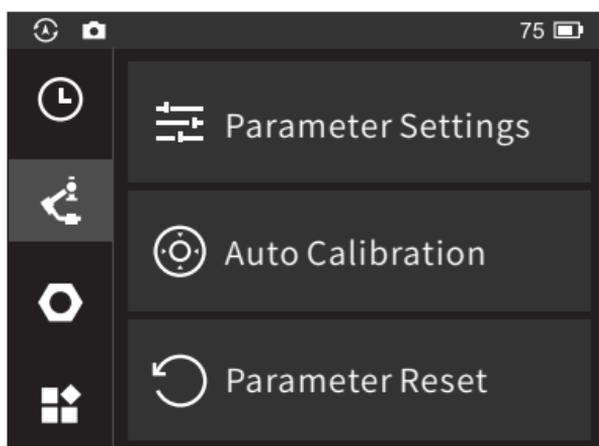
1. **Автокалибровка:** Автоматическая калибровка позволяет отрегулировать крутящий момент привода в соответствии с весом установленной камеры и объектива. Чтобы перейти в режим калибровки, выберите «Стабилизатор» - «Автокалибровка» и нажмите «Запуск». Вы можете следить за процессом калибровки на экране.
