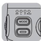
**Luzes indicadoras do modo do estabilizador (a luz F piscando indica o modo Ir, e a luz POV piscando indica o modo vórtex)**
