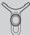
1 soporte del objetivo de la cámara 1 tornillo de bloqueo del soporte del objetivo
